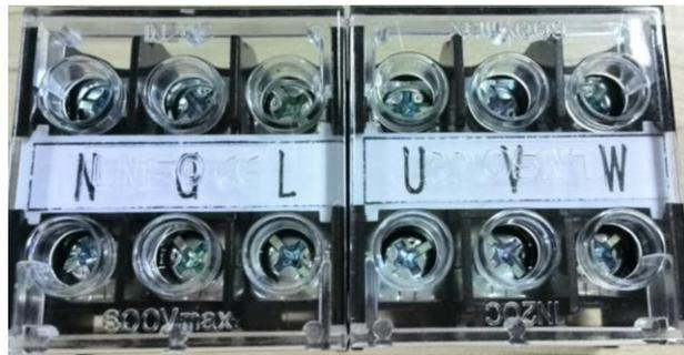
图 2-5 电源和电机接口图
